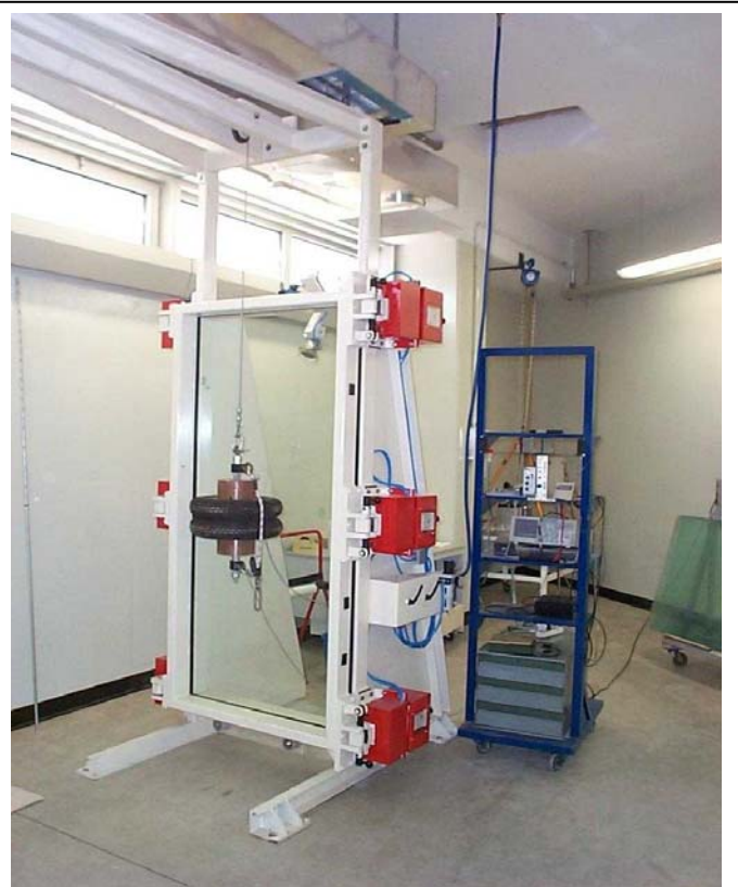
Figura n° 1 - Pendulum Tester (prEN 12600)
